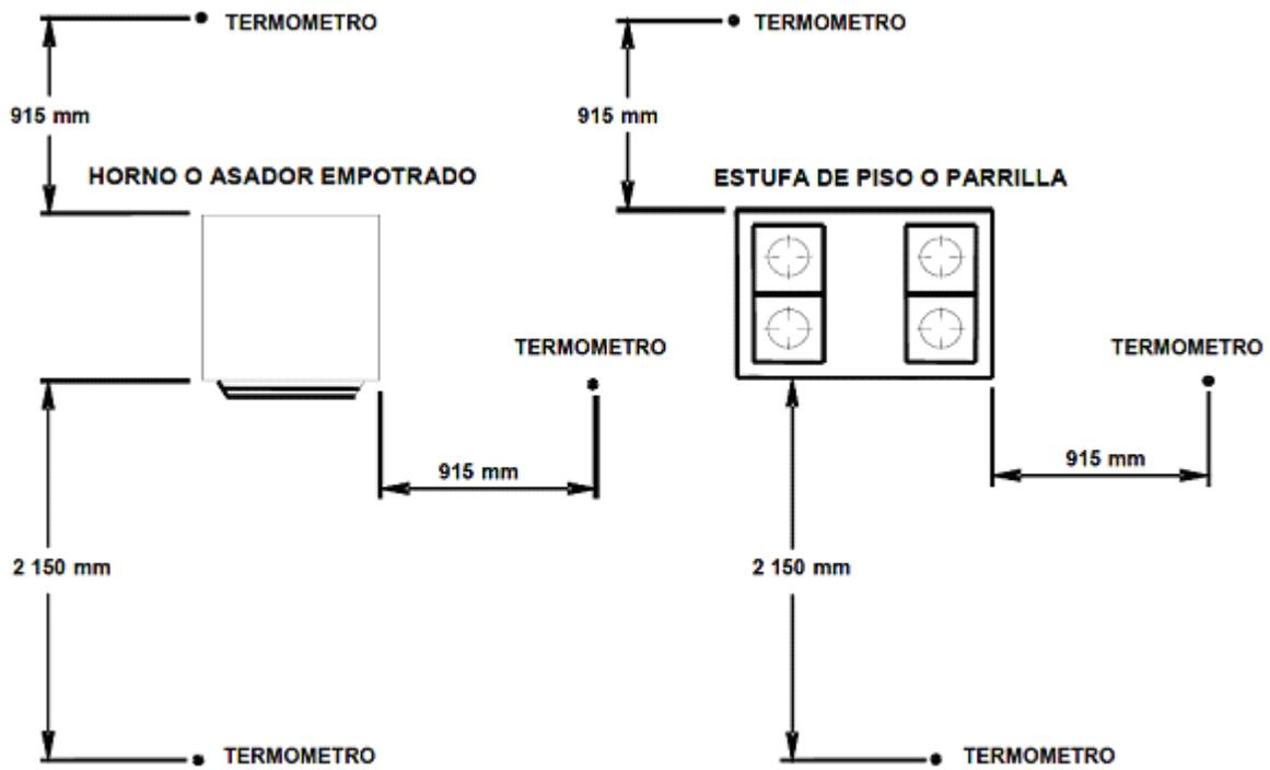
NOTA: Los termómetros se colocan a 1.52 m por arriba del nivel del piso
