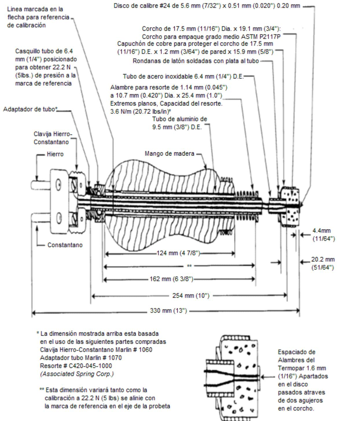
Figura 15. Probeta para medición de temperatura de superficies (ilustrativa mas no limitativa)
