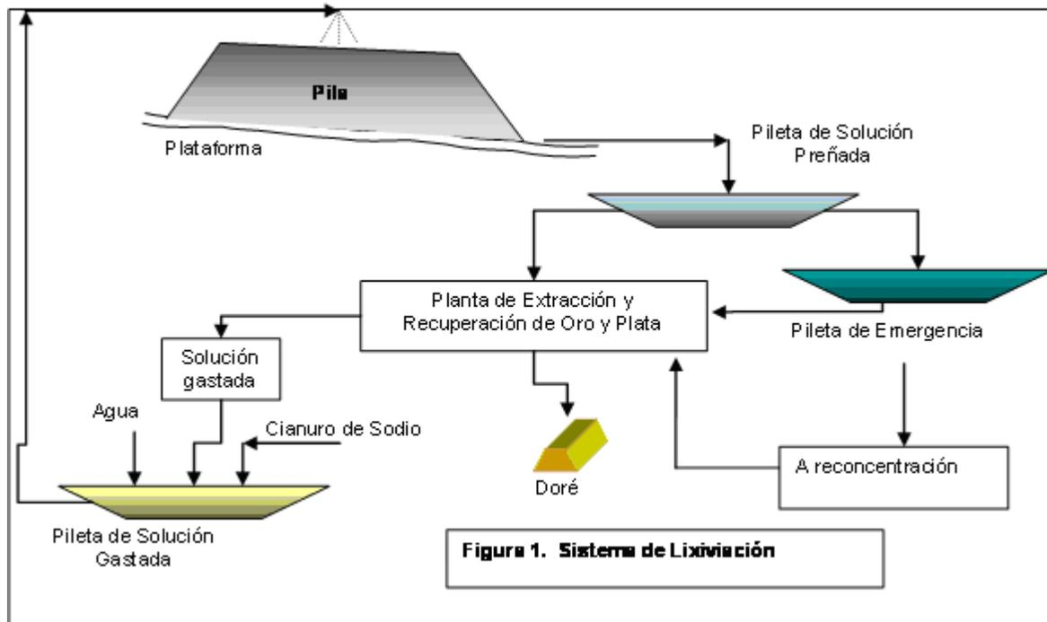
**Figura 1. Sistema de Lixiviación**
