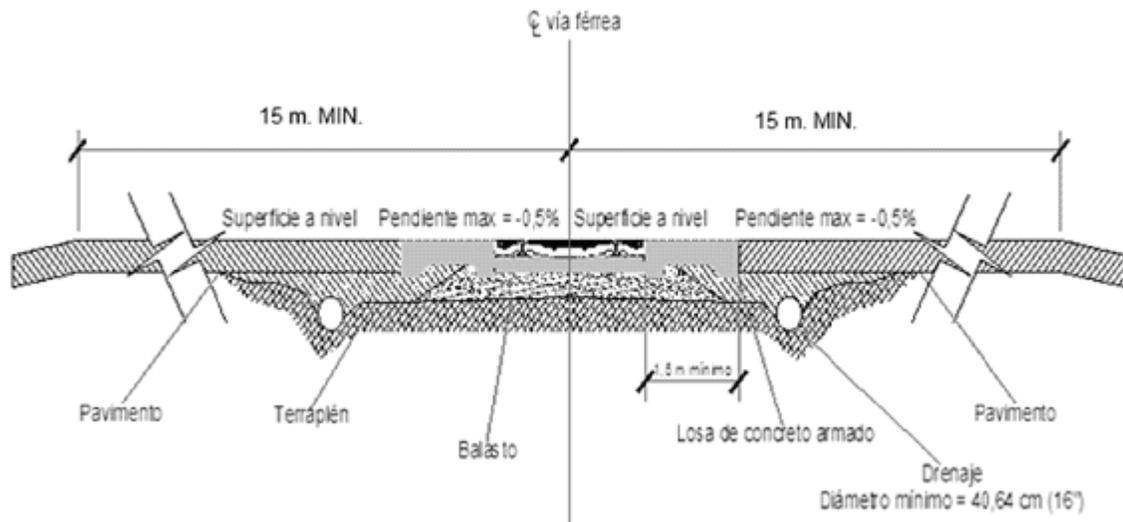
**Figura 3.** Corte transversal en un cruce a nivel.
