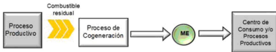
Figura 13 - Ubicación física de los sistemas de medición en procesos de Cogeneración tipo C
