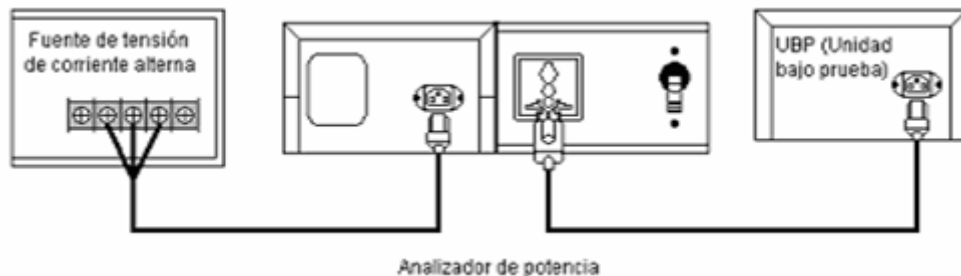
Figura 5. Arreglo de pruebas para las mediciones de potencia eléctrica en espera
