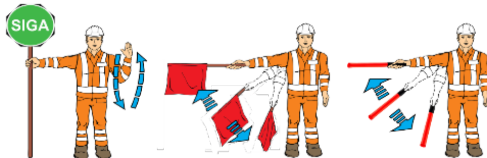
Alertar y disminuir la velocidad del tránsito
