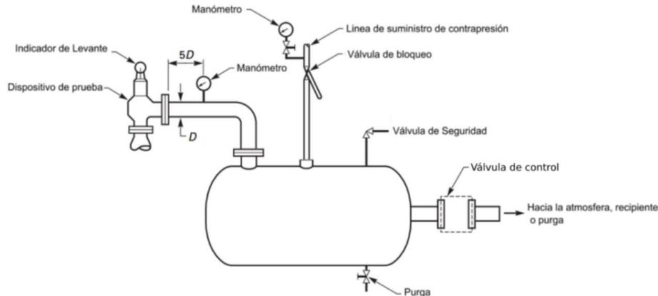
**Figura ilustrativa 15 - Arreglo para la prueba de contrapresión**
