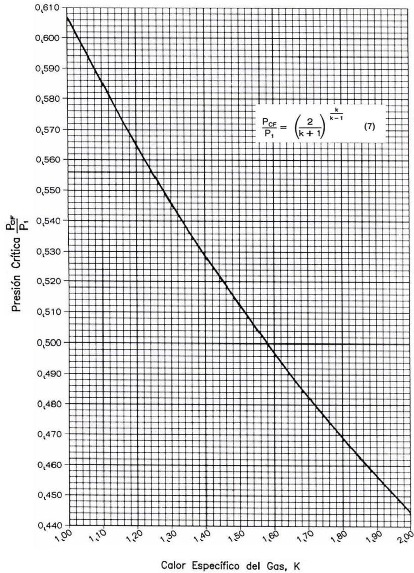
Figura ilustrativa C2 - Curva para determinar el valor de la presión crítica Pcf/P1
