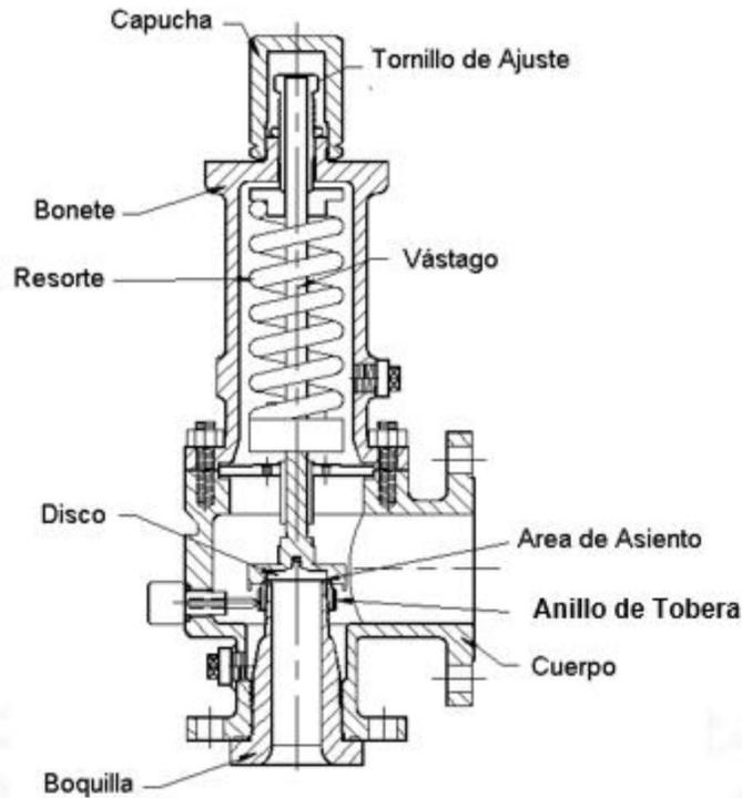
Figura ilustrativa 4 - Válvula de seguridad-alivio convencional
