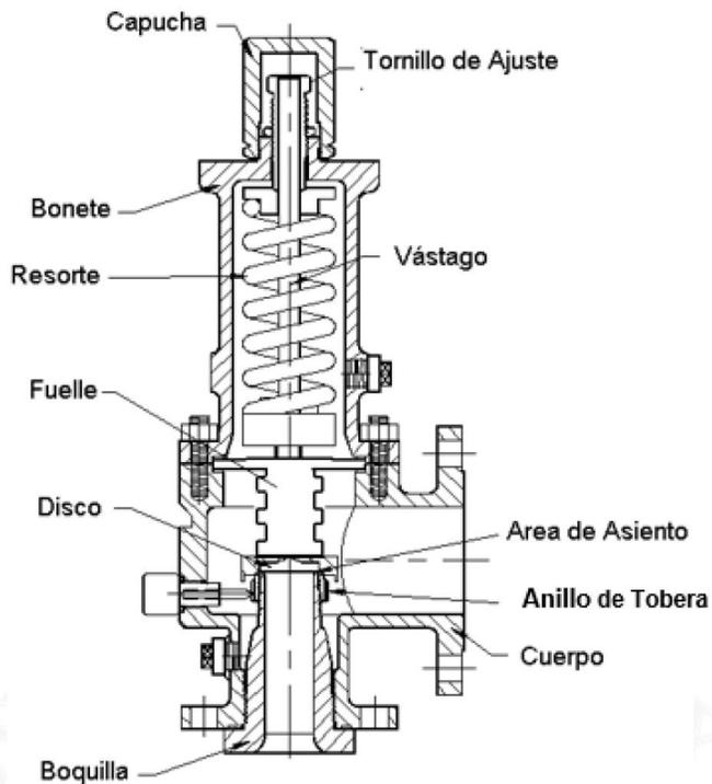
Figura ilustrativa 5 - Válvula de seguridad-alivio balanceada
