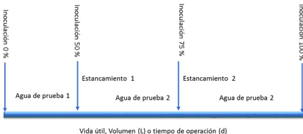
**A.11. Proceso de evaluación en el banco de pruebas, de los equipos en sistema continuo, por lotes (Discontinuo) y de las sustancias germicidas, para determinar la eficiencia en reducción bacteriana de la vida útil.**
