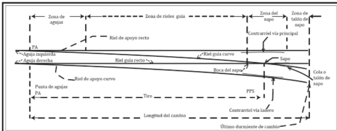
Figura 13 Nomenclatura de un cambio derecho.
