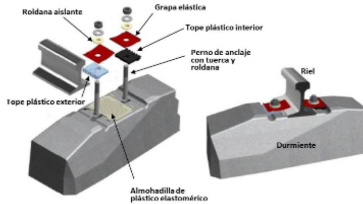
Figura 6 Sistema de fijación en vía elástica.
