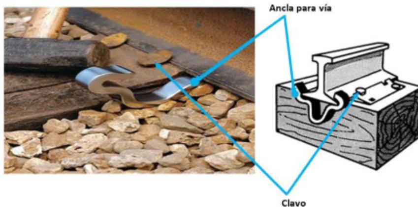
Figura 5 Sistema de fijación en vía clásica.
