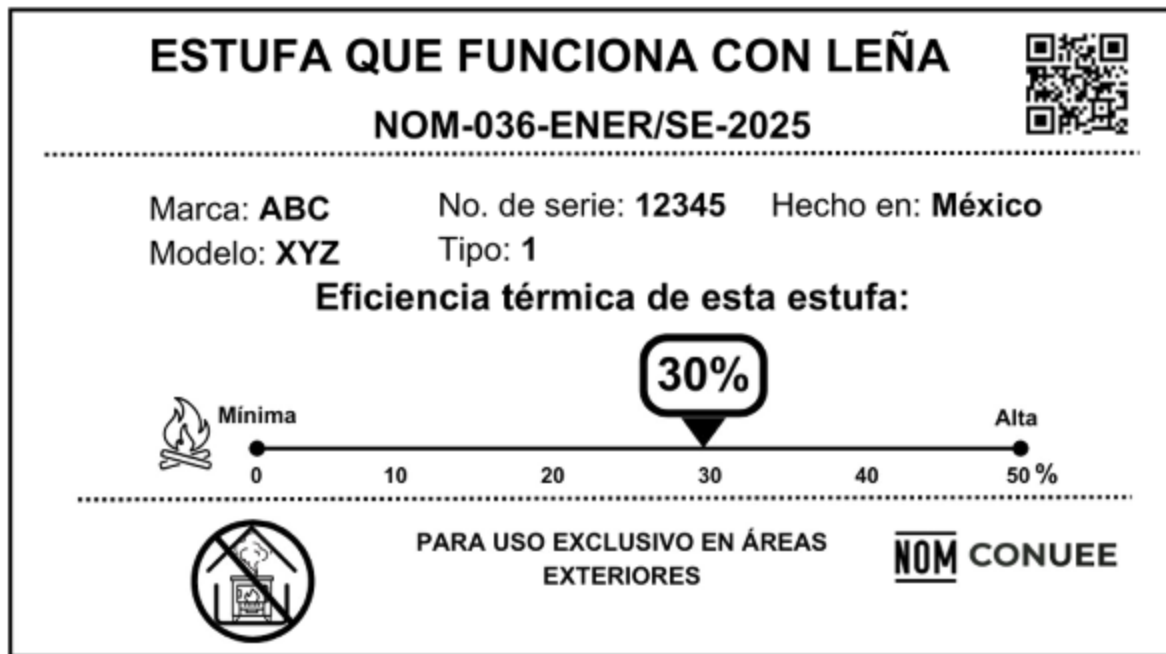
Figura 7 - Ejemplo de distribución de marcado para estufas que funcionan con leña con incumplimiento en la especificación de emisiones fugitivas
