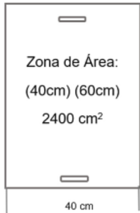
Figura E.2 - Ejemplo de cálculo del tamaño de la olla de BoPET para una plancha de 40 cm por 60 cm
