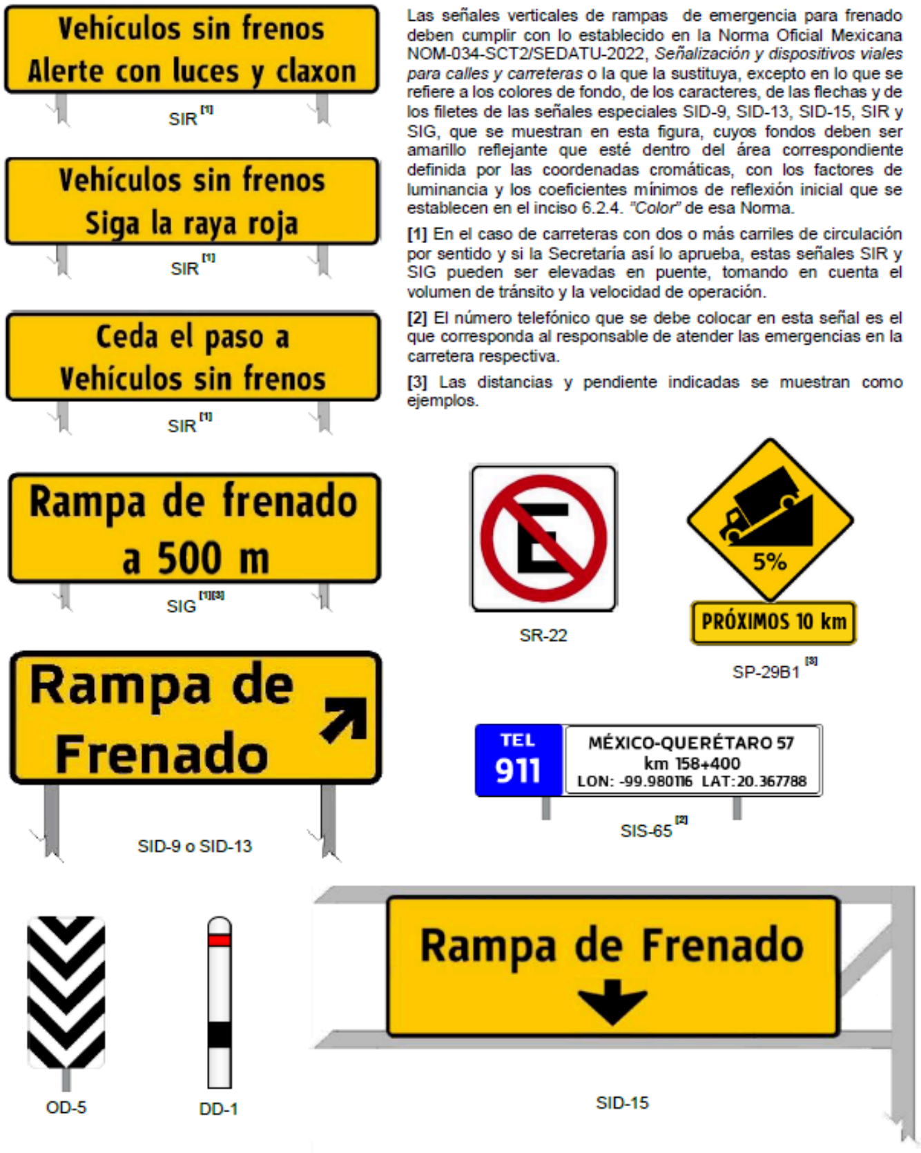
FIGURA 8.- Señales verticales de rampas de emergencia para frenado
