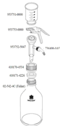
Fig. B.1.2-1 Partes del dispositivo de filtración
