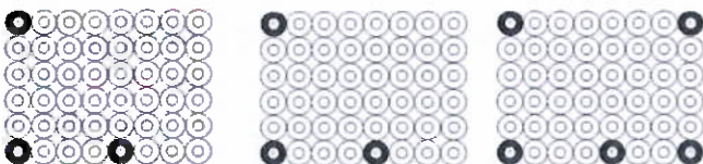
Figura E.10 - Colocación de sensores de prueba en parrilla de primer nivel
