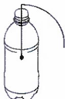
Figura E.5 - Colocación de sensor dentro de producto de prueba (PET o botella)
